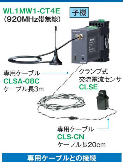
電流信号の検出はクランプするだけでOK！動力線の解放は不要です。
