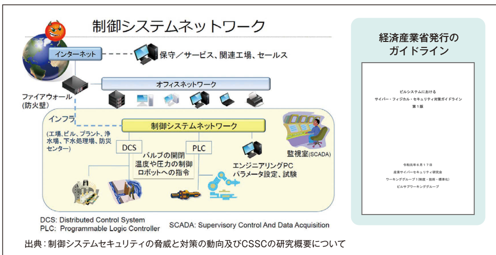
図2 制御システムネットワーク
