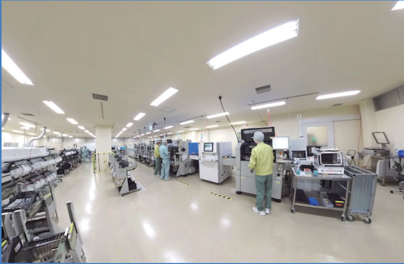
京都商品センターの変種変量生産マウンタによる生産工程
