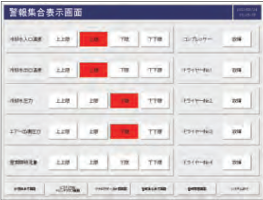
図2 SCADALINXproの警報画面 (画面はデバッグ時のものです)
