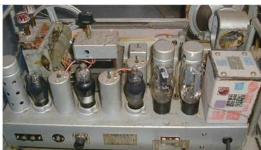
図1 真空管(ST管)を使用した高級ラジオ (写真: (株)カシ研 提供)
