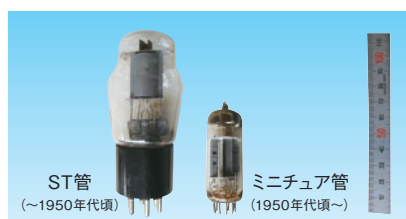
図3 高機能、小形化した真空管の進化 (写真：(株)カシ研 提供)
