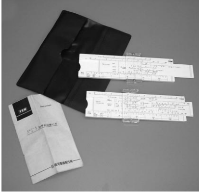
図3 計装用計算尺
