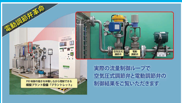
写真2 電動調節弁革命 空気圧式調節弁と電動調節弁の比較
